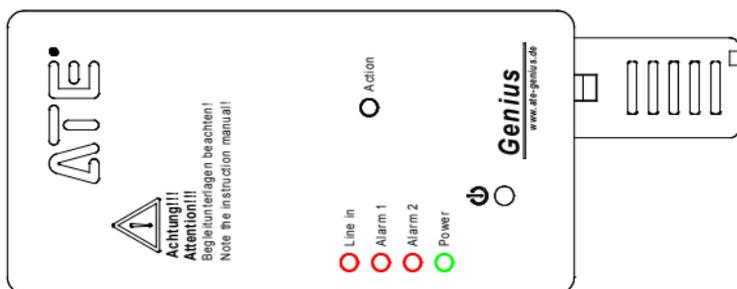
**Genius MN** verfügt zum einen über einen Netzstecker und kann mit einer Netzspannung zwischen 85 und 265 Volt betrieben werden. Die Netzfrequenz ist dabei nicht relevant. Selbst Gleichspannung wäre möglich. Die zweite Versorgung kann per Busleitung zwischen 9 und 30 Volt erfolgen. Auch hier ist die Frequenz, Polarität und Form der Betriebsspannung beliebig. Als dritte Variante verfügt **Genius MN** über eine eigene interne Notstromversorgung.
